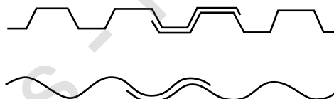
FIGUR AMA JVJ.21/3. SIDÖVERLAPP PÅ TAK.
